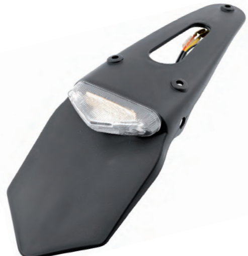
Piloto trasero transparente con guardabarros. Especial motos Off-Road. 12V/1.1W-0.2W. 6 leds. Con luz de matrícula (3 Leds Extra). Con orificios para intermitentes. Luz traseira transparente com guarda-lamas. Especial motos Off-Road. 12V/1.1W-0.2W. 6 LED. Com luz de matrícula. (3 LED extra). Com orificios para piscas.
