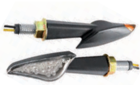
Juego Mini intermitentes de 15 Leds. 12V/1W. . 46x21 mm. Iluminación lateral extra.
